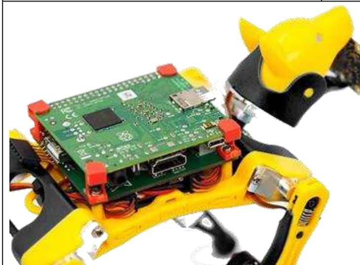
Perro Biónico montando una controladora Raspberry PI
