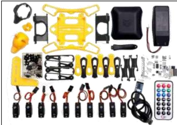
Componente del perro biónico sin ensamblar
